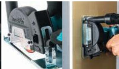
Regulação fácil e simples da profundidade. Possibilidade de incorporar um acessório de aspiração.
